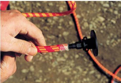
Nach dem Ablängen werden die entsprechenden Verbindungsstücke, hier zu sehen „Befestigungspacker“, komplett (bis Anschlag) in den Schlauch eingedreht.
