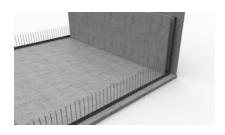
Das **SFE-Sollrissfugenprofil** ist fertig montiert, das nächste Hohlraumwandelement kann gestellt werden.
