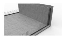
Das für die Montage im Eckbereich optimierte **SFE-Sollrissfugenprofil** wird senkrecht eingestellt und mit dem Sohle-Wand Dichtblech überlappt (Überlappung  $\geq 5$  cm).
