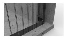
Der Überlappungsbereich auf dem Sohle/Wand- Dichtblech wird mit zwei Stoßklammern gesichert.
