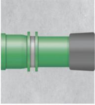
**KG 2000 Rohrdurchführung Typ FließRichtung** in der Wand einbetoniert.
