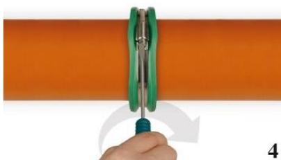
Das Spannband wird mit einem Schraubendreher so fest angezogen, dass sich der **RONDO Base** bei der Betonage nicht mehr verschieben kann. (ca. 5-6Nm)
