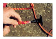
Une fois le tuyau coupé, visser entièrement (jusqu'en butée) les éléments d'assemblage correspondants (« injecteurs à clouer » illustrés ici) dans le tuyau.
