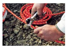
Le produit, d'une longueur de 100 m, est livré sur rouleau. Entourer le tuyau avec du ruban autocollant et le couper au centre à angle vif avec un outil approprié.
