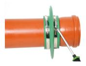
Les bandes de serrage sont serrées à l'aide d'un tournevis de manière à ce que le **collier mural RONDO** ne puisse plus être déplacé lors du bétonnage.
