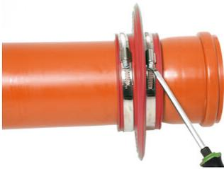
Les bandes de serrage sont serrées à l'aide d'un tournevis de manière à ce que le **collier mural RONDO Protect** ne puisse plus être déplacé lors du bétonnage.
