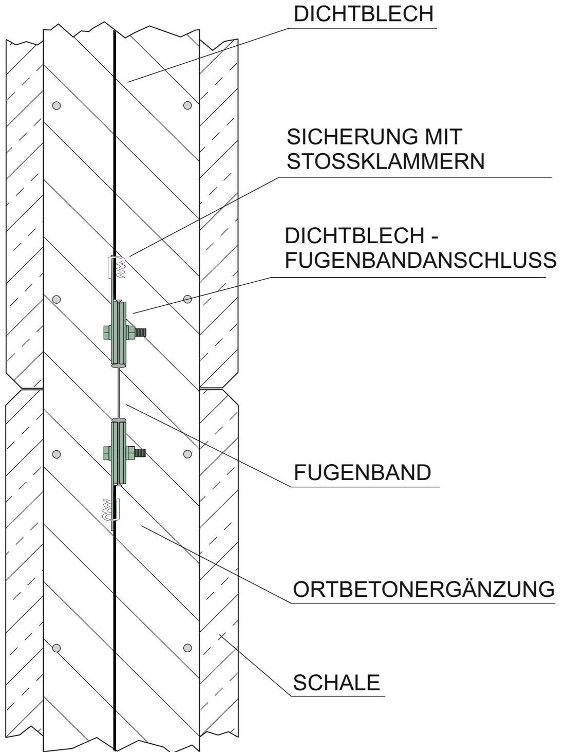
**DICHTBLECH - FUGENBANDANSCHLUSS
